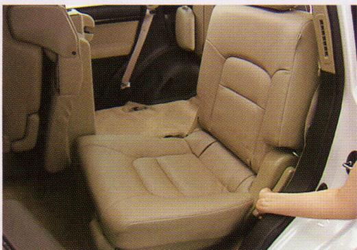
リクライニングレバーを倒すとシートバックが前に倒れます。
